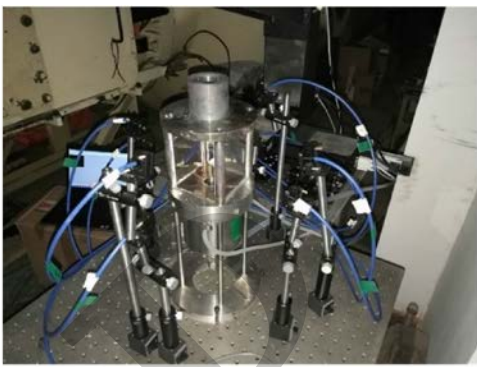
图 2 旋流燃烧器示意图及 3D-CTC 系统图(单位:mm) Fig. 2 Model combustor and the 3D-CTC setup (unit:mm)
